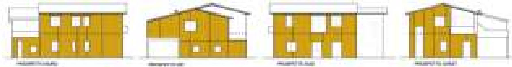
Figura 11 – Schema di taglio dei pannelli XLAM
