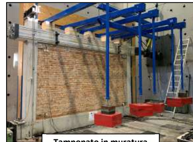
Tamponato in muratura
