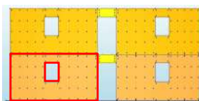
Rinforzo applicato a maschi e fasce, "pareti monolitiche" (RS3)
