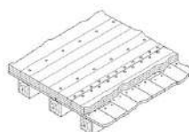
(e) "Soletta" con pannelli CLT o LVL
