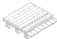
(e) "Soletta" con pannelli CLT o LVL
